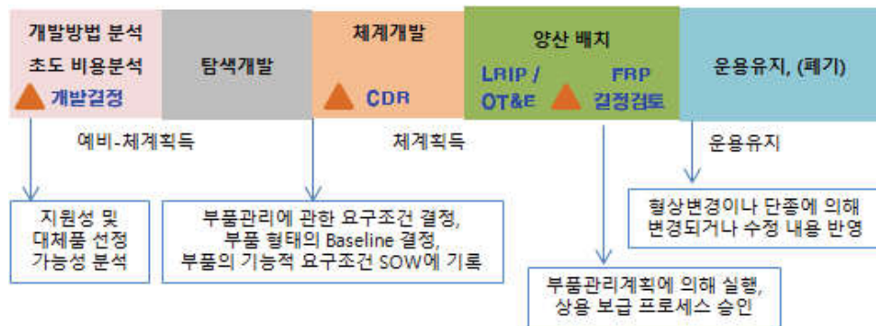
Figure 1. TLCSM 단계별 부품 표준화 적용 모델
